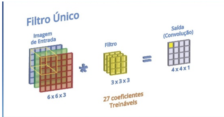
Figura 2.1: Demonstração de como os filtros funcionam em camadas convolucionais
