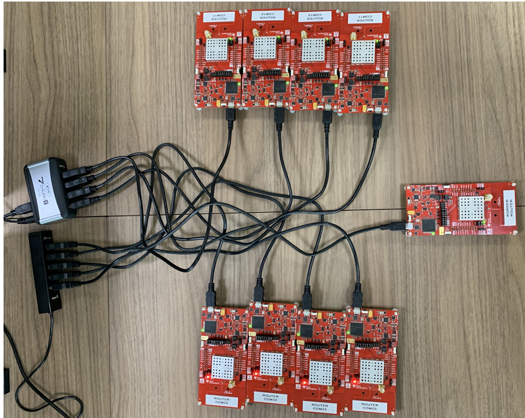
Figura 5.7: Montagem do testbed para os experimentos com o FRR.
