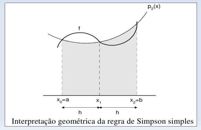
• Aplicando a regra de Simpson repetidas vezes no intervalo  $[a,b]=[x_{0,}x_{n}]$ . Vamos supor que  $x_{0,}x_{1,}...,x_{n}$  são pontos igualmente espaçados,  $h=x_{i+1}-x_{i}$ , e n é par (isto é condição necessária pois cada parábola utilizará três pontos consecutivos). Assim teremos:
