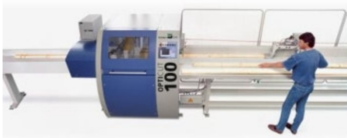
Figura 1. Exemplo de uma máquina de otimização de corte. Operador alimenta a máquina e normalmente delimita com giz fluorescente as regiões com defeitos.
