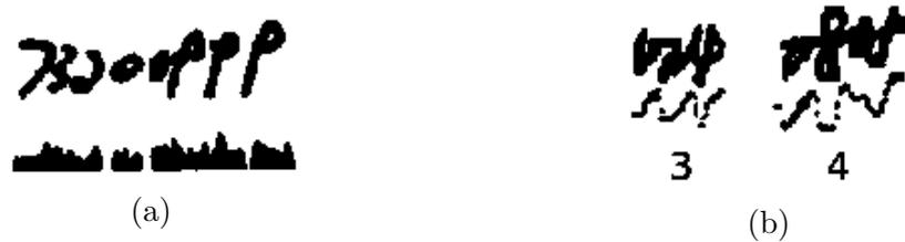
Figura 3.7: Chuang et al. (2005): (a) Determinação dos componentes conexos pela projeção do histograma e (b) Determinação da quantidade de dígitos de um componente pelo número de cristas.
