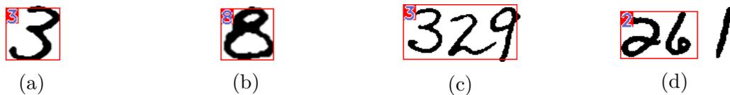
Figura 4.18: Detecções do modelo treinado a partir de dígito isolados (apenas): (a) e (b) representa a correta detecção de dígitos isolados, (c) e (d) são classificações errôneas causadas por aprendizado errôneo do contexto.
