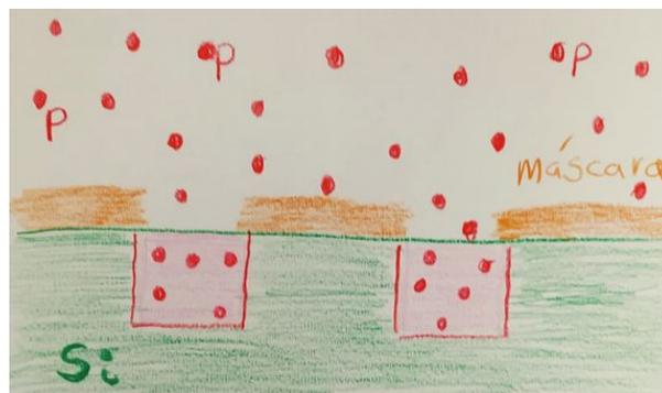
Figura 5.1: Dopagem de silício pela difusão de fósforo, vista lateral.
