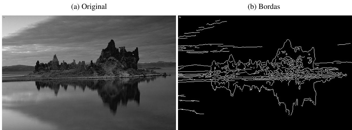
Figura 2.2: EXEMPLO DE SAÍDA DO DETECTOR DE BORDAS CANNY.
