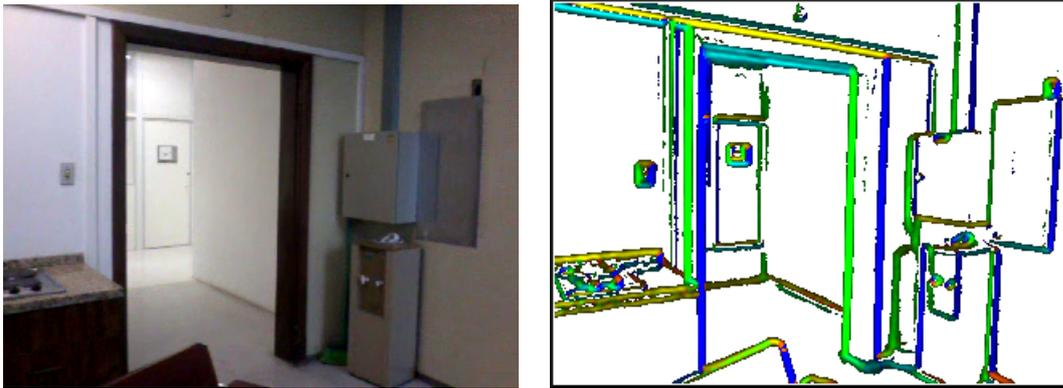
Figura 13: A figura a esquerda mostra a imagem original e a direita a orientação de cada ponto, sendo que a cor azul indica  $0^\circ$ , Amarelo  $90^\circ$ , Verde  $180^\circ$  e ciano  $270^\circ$ . Figura do autor.
