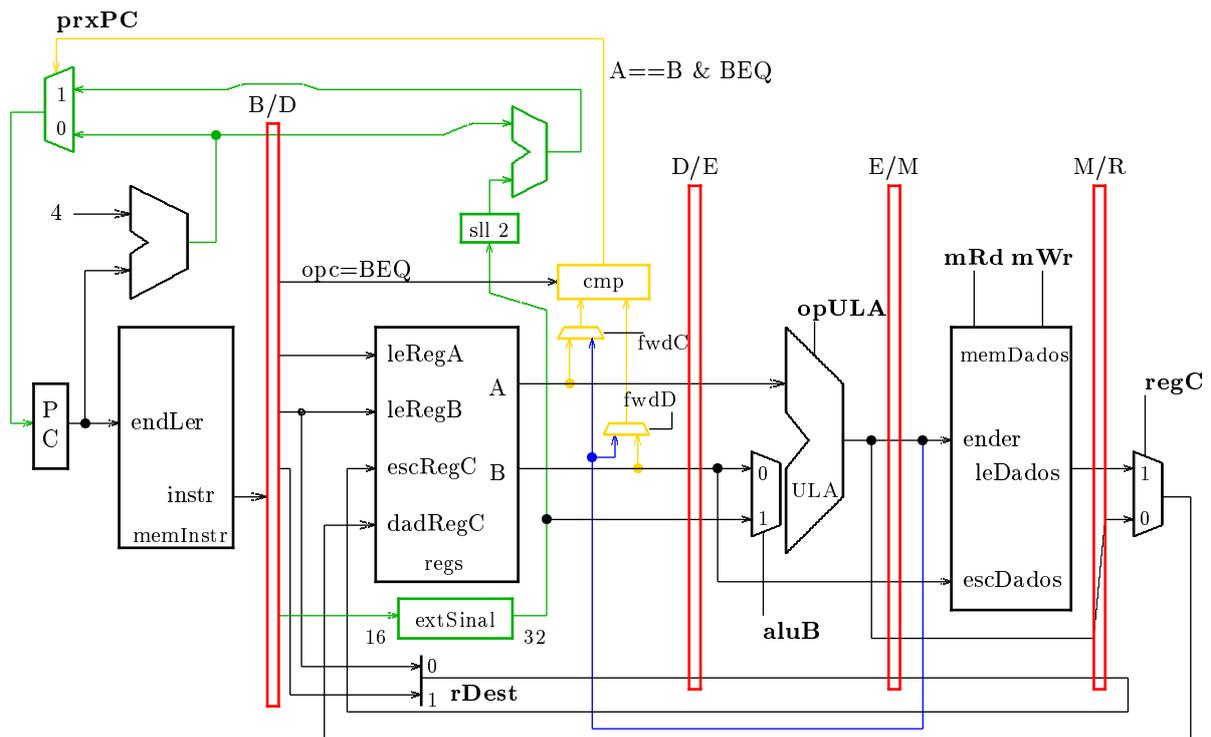
1) Considere a execução do trecho de programa ao lado no pipeline original de cinco estágios (com bloqueios e adiantamento) do MIPS-I. Quantos ciclos serão necessários para executar este código? Desenhe um diagrama que mostra as dependências, e outro diagrama que mostra como o código será executado (mostrando as bolhas e/ou adiantamento).
