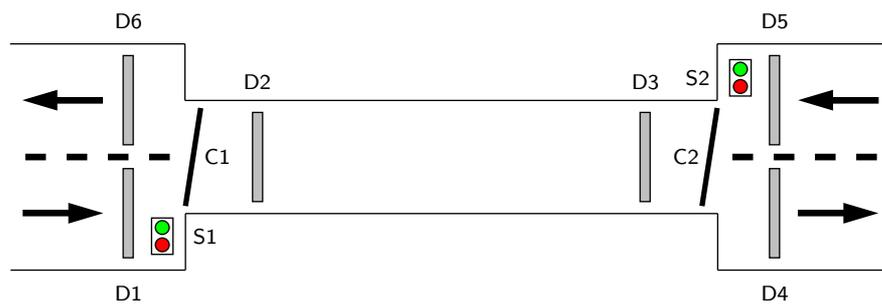
Figura 16.37: Uma estrada de montanha com duas cancelas,  $C1$  e  $C2$ , seis sensores (detectores),  $D1$  a  $D6$ , e dois semáforos,  $S1$  e  $S2$
