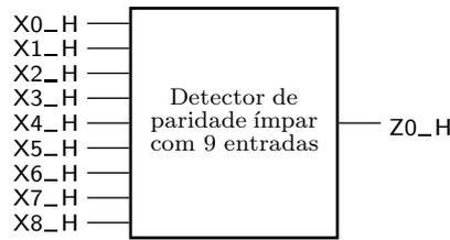
Figura 8.4: Diagrama de blocos de um detector de paridade ímpar com 9 entradas e 1 saída, todas activas a H
