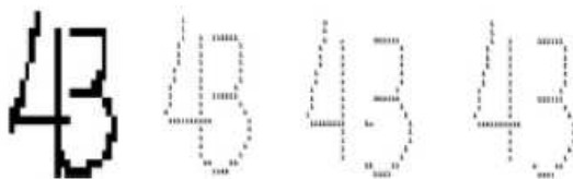
Figura 15: Imagens das fases do método de segmentação: imagem original, imagem esqueletizada, imagem segmentada e imagem restaurada.
